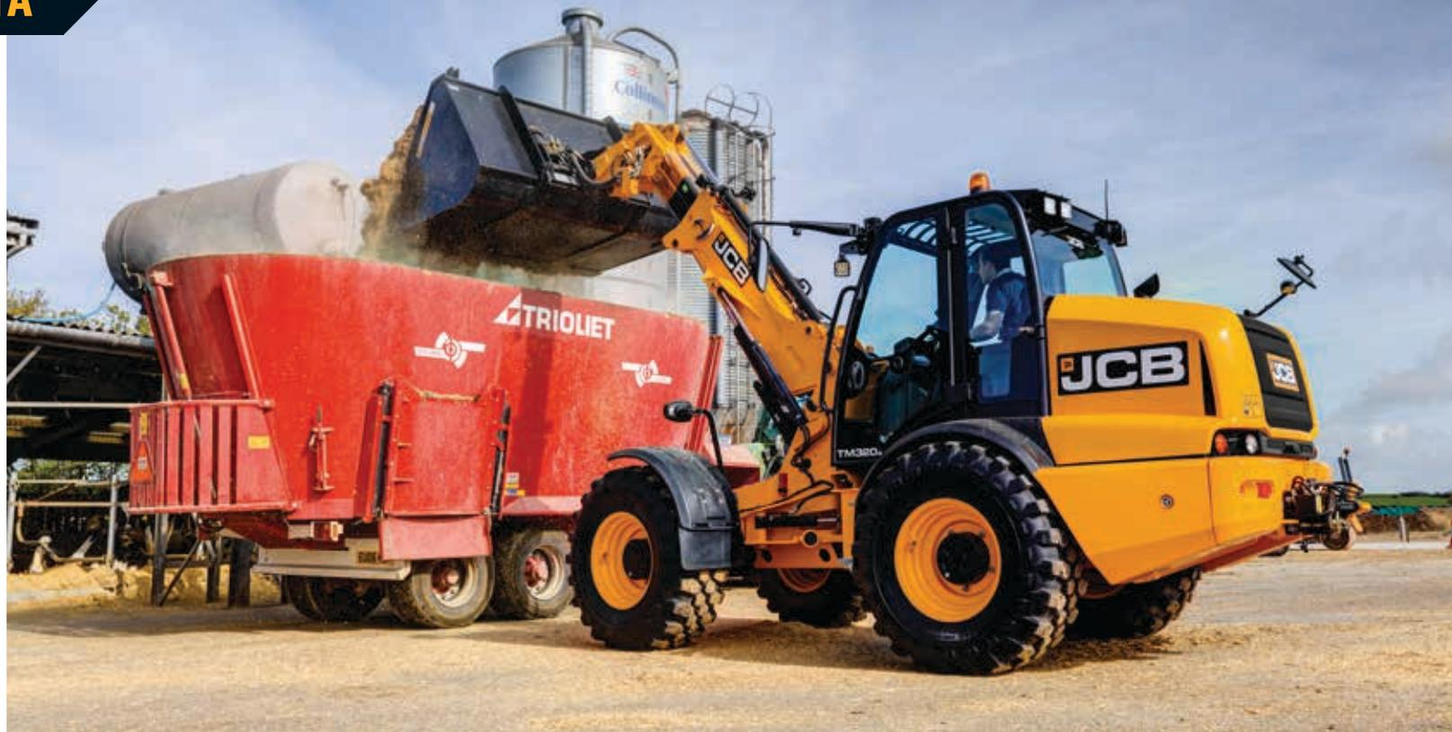
El bloqueo de convertidor de par en la transmisión ofrece un 100 % de eficiencia en todas las marchas para reducir el consumo de combustible.
